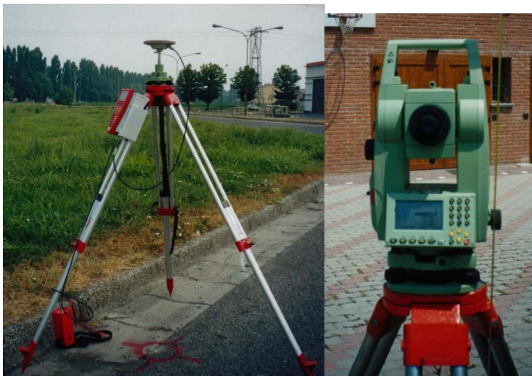
Per il rilievo delle quote dei bocca-pozzo, si è posizionato un ricevitore GPS sul vertice della rete (MASTER), ove è rimasto fisso per tutto il tempo del rilievo, mentre un ricevitore (ROVER) si spostava ad ogni punto del quale era necessario determinare la quota.
