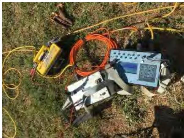
Ripresa fotografica della strumentazione utilizzata per l'acquisizione della linea tomografica.
